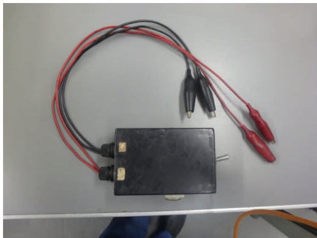
F C 日本初の紹介：消火ポンプ自動復旧器
